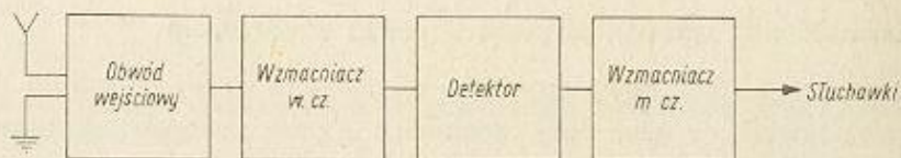
Rys. 14-6. Układ blokowy odbiornika o bezpośrednim wzmacnieniu
